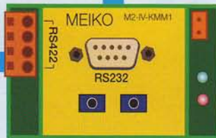
Communicatie module met aansluiting voor RS 422 en RS 232
